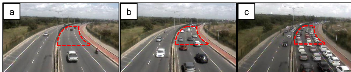
Figura 26 – Exemplo do tráfego a) livre b) intermediário e c) congestionado. A área marcada corresponde ao trecho onde fluxo e densidade são analisados
